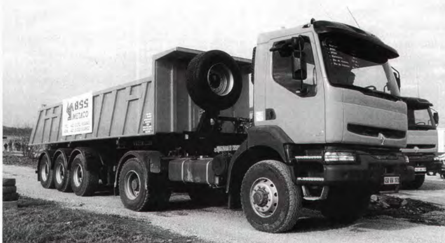
Kerax 385.19 T 4x4 – návěsový tahač – hmotnost: pohotovostní 8200 kg, užiteč- ná 10 800 kg, celková 19 000 kg, cel- ková souprava (s návěsem) 40 000 kg; délka- xšířkaxvýška: 5700x2500x 3200 mm; roz- vor náprav 3500 mm. Základní provedení s krátkou kabinou a se sklápěcím návěsem z BSS.
