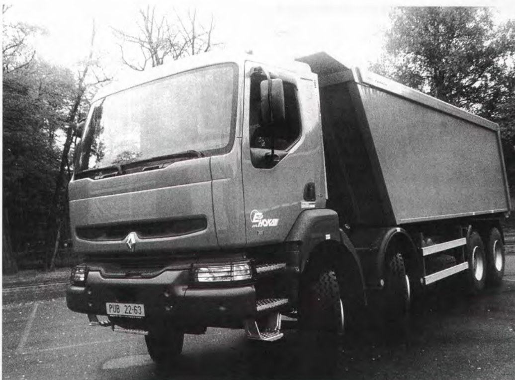
Kerax 385.40 8x4 S1 – hmotnost: pohotovostní 13 690 kg, užitečná 18 310 kg, celková 32 000 kg, celková souprava (s přívěsem) 48 000 kg; délkaxšířkaxvýška: 9420x2500x3174 mm; rozvory náprav 1740 + 3323 + 1350 mm. Jednostranné sklopná korba Kremen.
