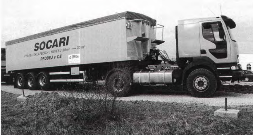
Kerax 385.19 T 4x2 – návěsový tahač – hmotnost: po- hotovostní 7380 kg, užitečná 11 620 kg, cel- ková 19 000 kg, celková souprava (s návěsem) 40 000 kg; dél- kaxšířkaxvýška: 5900x2500x 3114 mm, roz- vor náprav 3500 mm. Prodloužená kabina (Profonde) s celoplošným prosklením pravých dveří pro zlepše- ní výhledu řidiče na pravou stranu.
